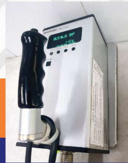
Máy đo độ dày lớp phủ Antifinger – Kurabo – Nhật Bản Coating thickness gauge Antifinger - Kurabo - Japan
